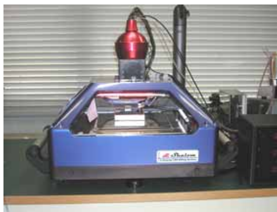
図1 卓上型高速ミ-リングマシン
