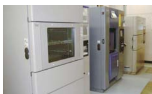
導入・更新した環境試験機器
