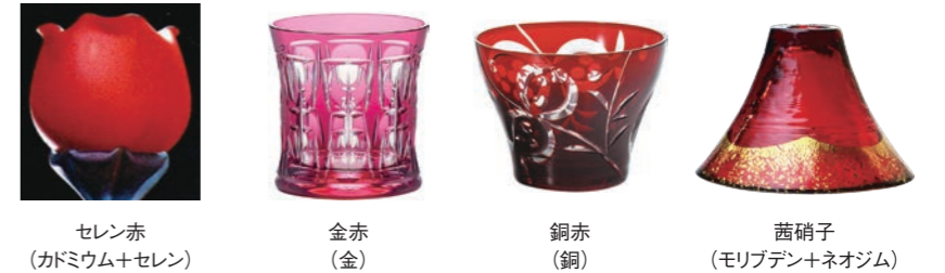
図1 着色剤の違いによる赤みの違い セレン赤と金赤・銅赤、開発した茜硝子の比較。茜硝子の色みはセレン赤と遜色ありません。
