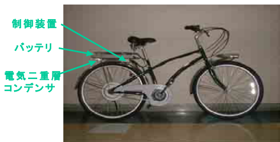
図 11 電流供給システムを搭載した電動自転車外観
