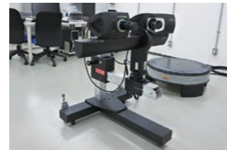
パターン投影式三次元デジタイザ カメラ解像度：11 M Pixel 測定点間ピッチ：18 ~ 225 μm ※測定物の大きさにより異なります
