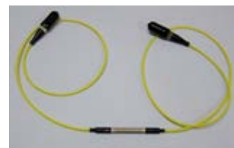
図 1. 温度と波長変化との関係を求めた「高精度型光ファイバー温度計」
