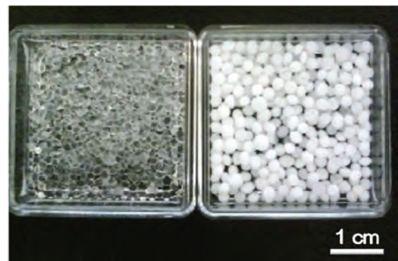
図 4 SMPS ビーズの外観写真 (左:SMPS ビーズ、右:SMPS ナノ粒子ビーズ)
