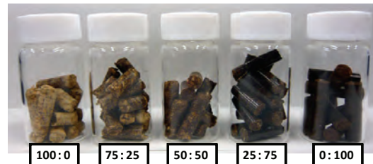
図2 低質材（木部）と廃樹皮の混合ペレット (枠内数値は木部：廃樹皮の混合比率)
