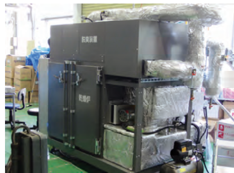
図 5 塗装乾燥炉用触媒処理装置
