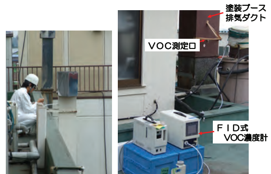
図1 塗装工場でのVOC実態調査
