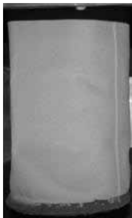
図 2.5.4.5a 塗装ミスト付着後の全体写真
