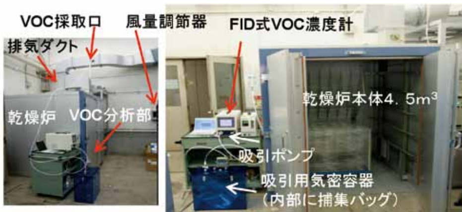
図 2.5.5.5 乾燥シミュレータ実験装置
