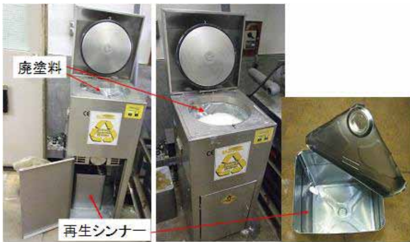
図 2.4.3.16 溶剤再生装置による廃シンナーの再生利用
