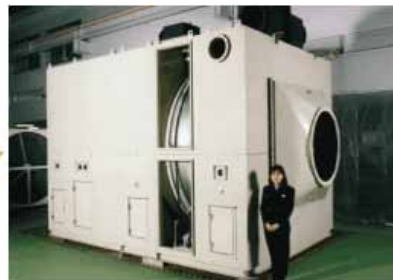
図 2.5.2.2 ゼオライトを使用した VOC 濃縮装置の原理と製品例
