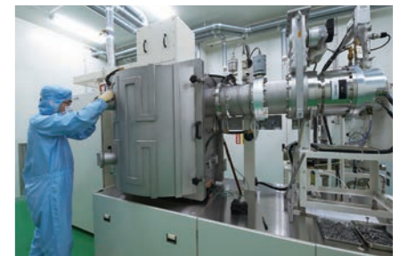
成膜装置を設置したクリーンルーム((株)フジメタル)前処理の洗浄工程も純度100%に近い超純水で行う設備が整っており、成膜環境の影響をあまり受けてサンプルを作製することができる
