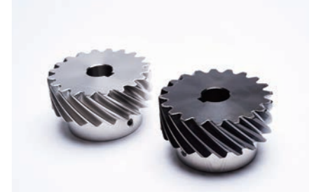
塩素含有DLC膜を施す前後の製品サンプル 左/成膜前 右/成膜後
