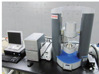
動的粘弾性測定装置 (レオメータ) 円盤状の2枚のセンサーにサンプル (液体、固体) を挟み込み、微小振動や回転を与えたときの応力を測定する装置
