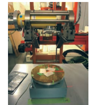
X線照射装置 (160kV) による、 照射処理される輸血血液管理用 RFIDタグの信頼性試験の様子
