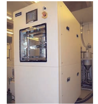
ナノインプリント装置 大面積のナノパターンを作製可能
