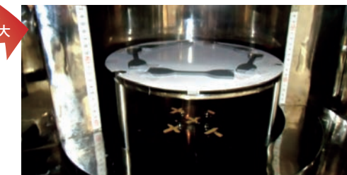
遮水高分子シート材料の耐放射線試験 (ガンマ線照射) ダンベル状に打ち抜いたシートにガンマ線を照射後、引張試験等を行い、シートの性能を評価
