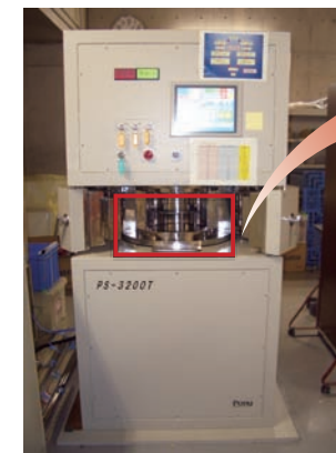
セシウム 137 自己遮蔽型 ガンマ線照射装置
