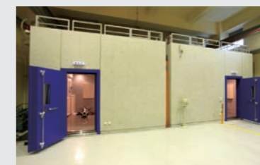
音響材料の透過損失測定、床衝撃音レベル測定
