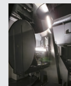
配光装置 照明器具の配光 特性を測定
