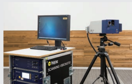
振動形状を可視化するための スキャニングレーザー振動計
