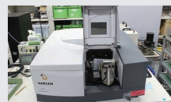
フーリエ変換赤外分光光度計 (FT-IR) 各種材料などの分光放射率・反射率・透過率測定
