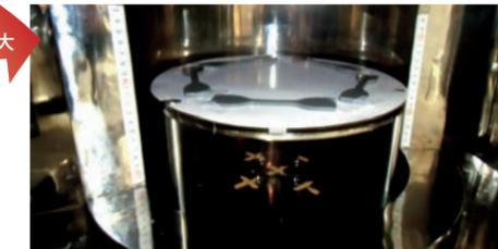
遮水高分子シート材料の耐放射線試験 (ガンマ線照射)
