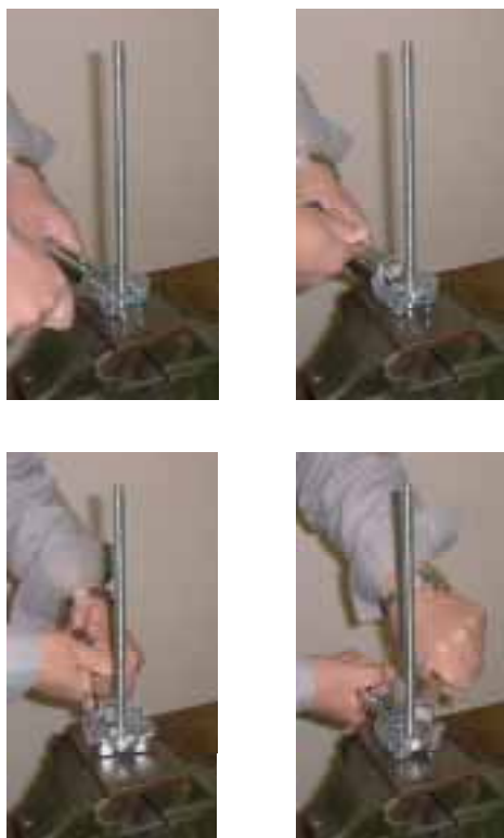
図2 専用工具の操作方法
