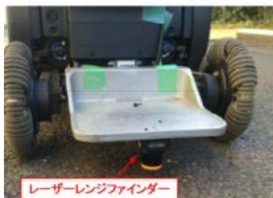
図 2. フットプレートに取り付けたレーザーレンジファインダー
