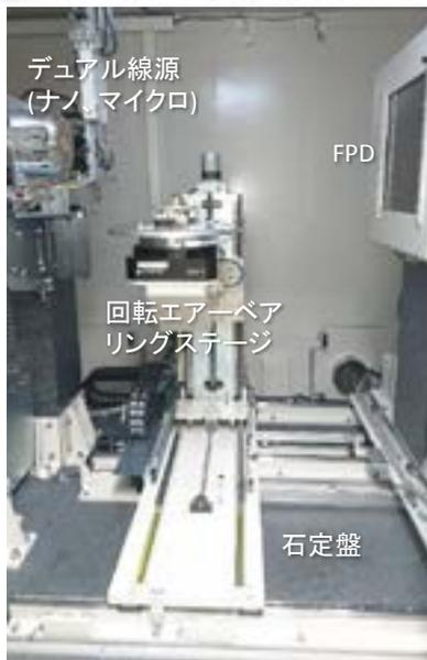
図1 高精度X線CT装置
