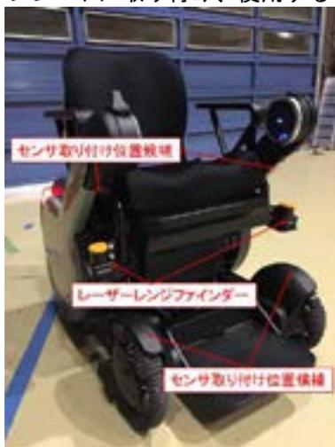
図 1. レーザーレンジファインダーを有する WHILL Model A
