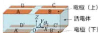
図1. 静電容量型変位センサの構成 [1]
