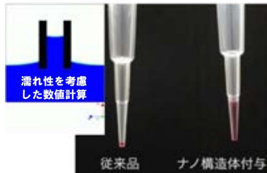
ナノ凹凸微細成形だけによる毛細管現象発現
