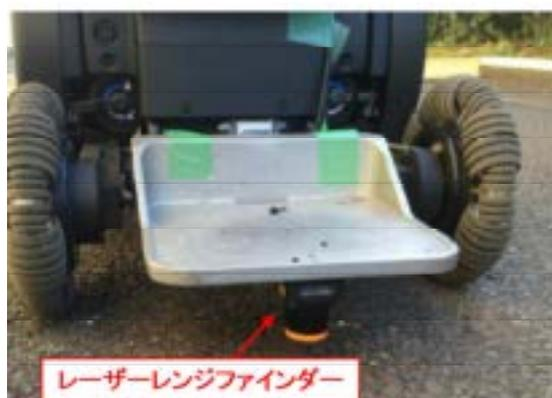
図 2. フットプレートに取り付けたレーザーレンジファインダー
