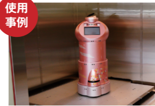
加振台の上にロボットを固定し、振動と同時に温度・湿度を変えて試験
