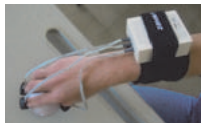
図1. 感性計測システム （指の接触力センサー）
