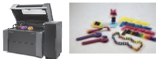
図4. カラー AM (3D プリンタ) と試作例
