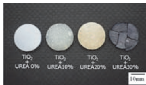
図1. 作製した可視光応答型光触媒焼結体
