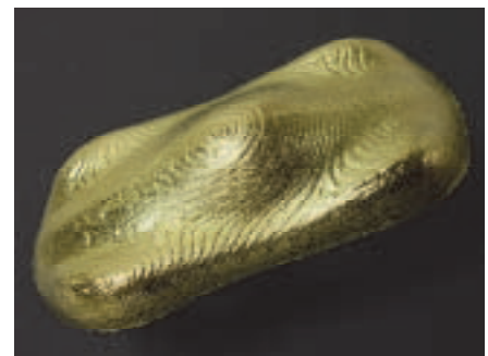
図 1. ナイロン樹脂 AM 立体モデルへのめっき完成品
