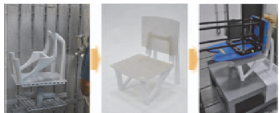
図4. 試作及び強度試験
