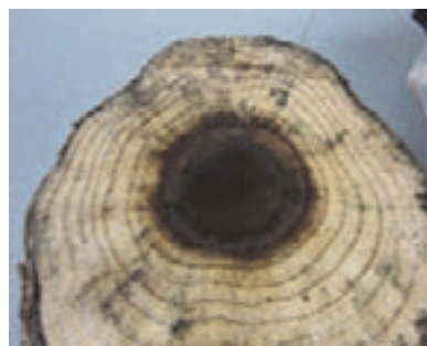
図1. 青変菌による変色 (スギ材)
