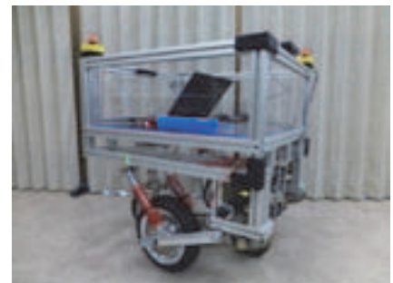
図 2. 運搬ロボット試作機
