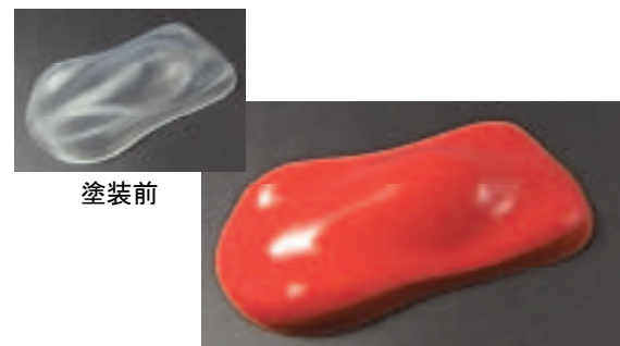
図 1. 光硬化性樹脂 AM モデルへの塗装前後の外観写真
