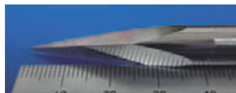
図 2. 電解研磨した穿刺針
