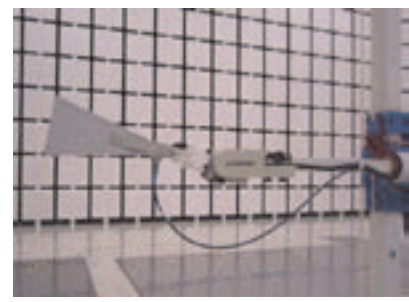
図 3. 狭ビームアンテナと仰角制御
