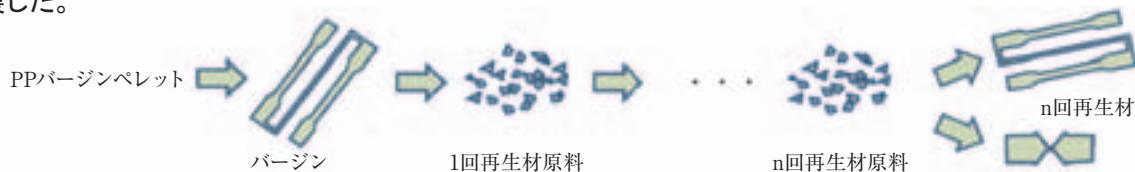
図1. 成形と粉碎の繰り返しによる再生ポリプロピレン試験片の作製
