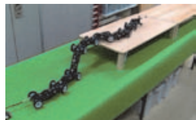
図3. 段差昇りの様子 [4]
