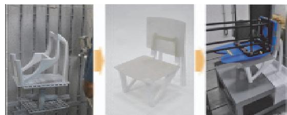
図4. 試作及び強度試験
