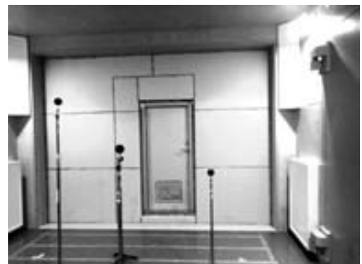
図 2. 船舶居住区用ドア（試験室内）
