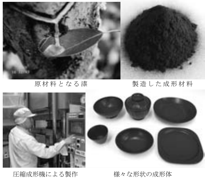
図1. 新素材「サスティーモ ® 」の製造工程
