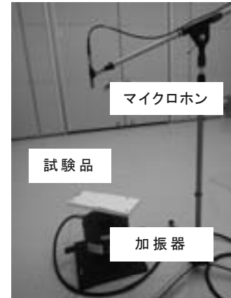
図1. ラトル試験時の様子
