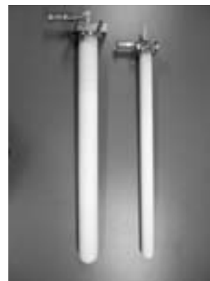
図 1. 左：高精度共晶点セル 右：実用型共晶点セル
