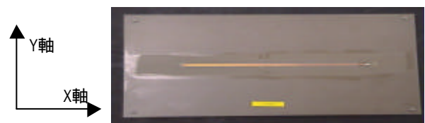
図2 マイクロストリップ線路構造のノイズ源
