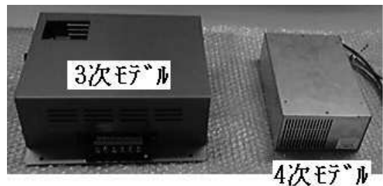
図2. 試作した力率改善装置
