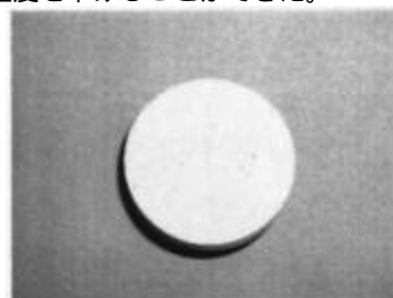
写真2 焼成したブロック片 (750 )
