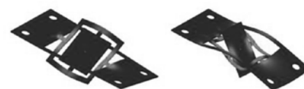
第5次モード 第7次モード 図2. 固有振動シミュレーション
