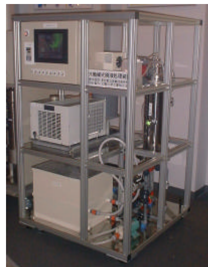
図4 光触媒処理装置
