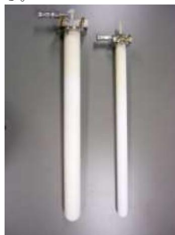
図1 左：高精度共晶点セル
