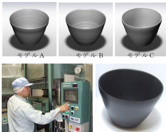
図 2 3DCAD 設計およびバイオマス成形体の製作
