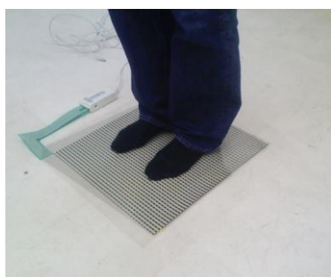
図1 足裏圧力の測定装置
