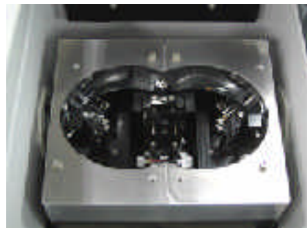
図1 FT-IR 試料室に設置した STAR GEM
