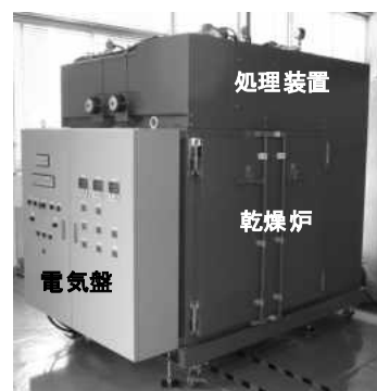
図1 塗装乾燥炉用 VOC 処理装置試作機
