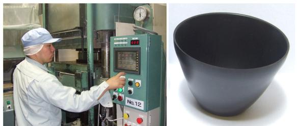
圧縮成形機による製作 ぐい呑みC形状成形体
