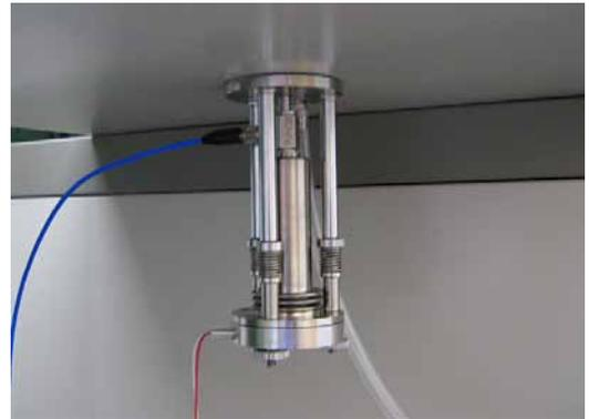
図1 オンサイト型超微小硬さ測定機
