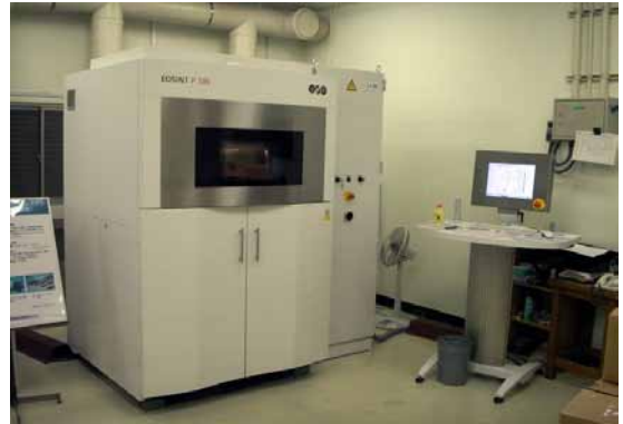
図1 ナイロン粉末焼結型 RP 装置
