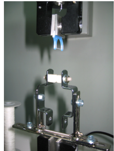
図1 人工歯による実用性評価
