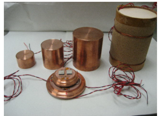
図1 熱分析装置（試料室部）
