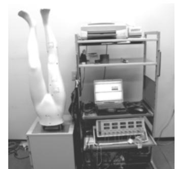
図2 脚形ダミー評価装置
