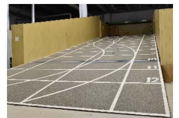
安全認証技術支援 傾斜路走行性試験装置 (傾斜した床の上をロボットが 倒れずに走行できるか確認)
