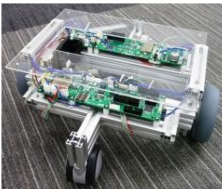
T型ロボットベース 作製：都産技研
