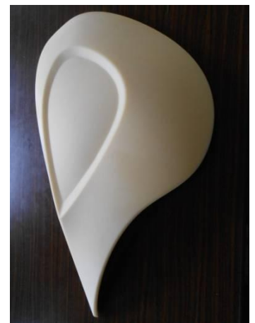
羽の切削加工部品 切削加工：日野市内企業 ABS樹脂の切削加工
