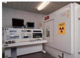
X線透過検査装置
