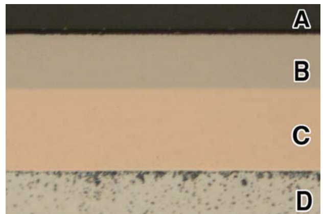
図2 めっき皮膜断面観察（倍率：500倍）
