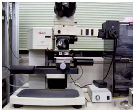
図1 マイクロスクラッチ試験機
