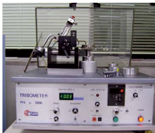
図2 ボールオンディスク摩擦摩耗試験機
