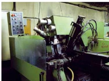
図1 丸鋸自動研磨機
