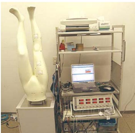
図4 パンスト衣服圧測定用評価装置
