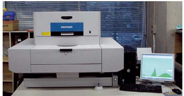
図1 エックス線分析顕微鏡 (大型試料室タイプ)
