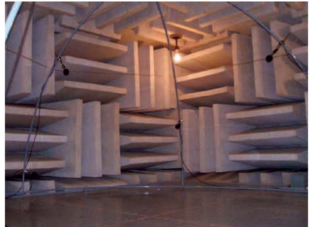
図1 半無響室 外部の音を遮断した静かな部屋
