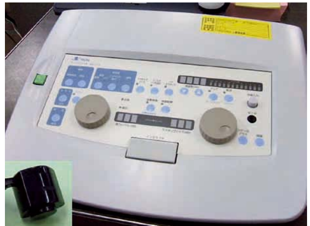
図2 オーディオメータと骨伝導スピーカ(左下) RION Audiometer Type AA-77A 聴力を測定するための機器
