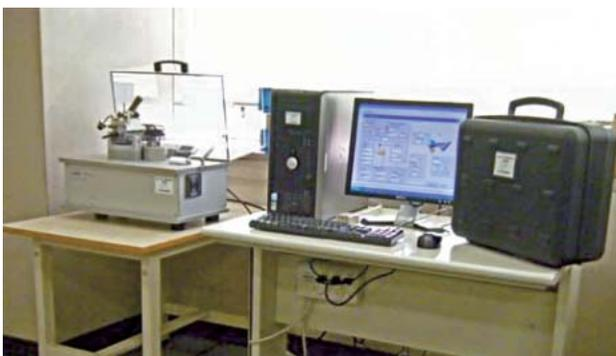
図1 ボールオンディスク摩擦摩耗試験機外観
