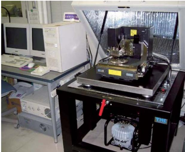
図3 原子間力顕微鏡外観
