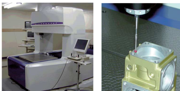
図1 三次元座標測定機と部品測定の様子
