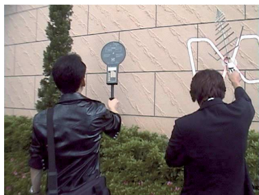
図3 都市空間ノイズ分布の現地調査 都内の区役所の依頼で、現地調査を行っている風景 右がノイズ測定用多素子アンテナ、左は市販磁界センサ
