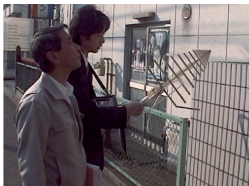
図2 製作アンテナのフィールドテスト 屋外で高周波ウェルダの発生電波を検出する実験を行った結果、70m遠方においても検出が可能でした
