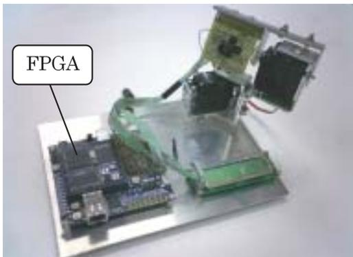
図1 FPGAによる組み込みシステム実習教材
