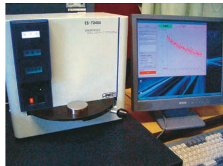
図 2 . 新開発の照射食品検知用 PSL 装置
