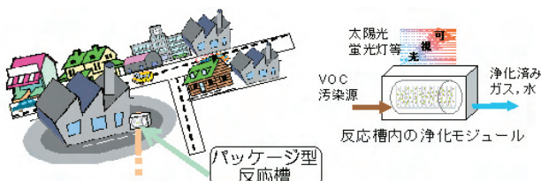
図6 開発する土壌中のVOCガス処理装置
