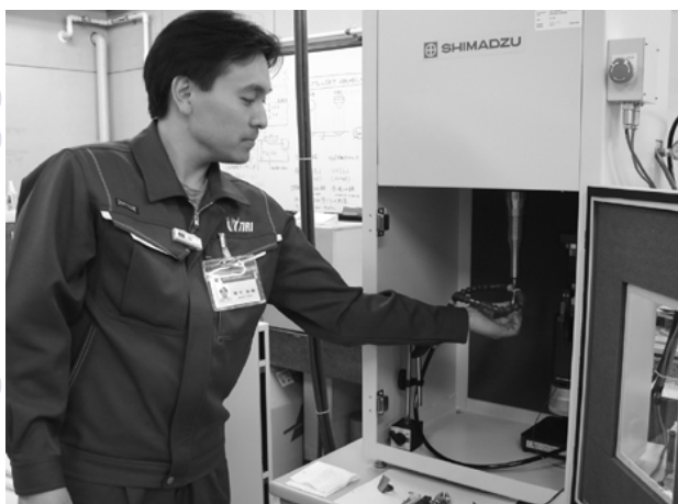
写真5 強度・疲労試験法の開発 バイオニクス材料や微小部品の強度試験法・ 疲労試験法を開発し、依頼試験に活用しています
